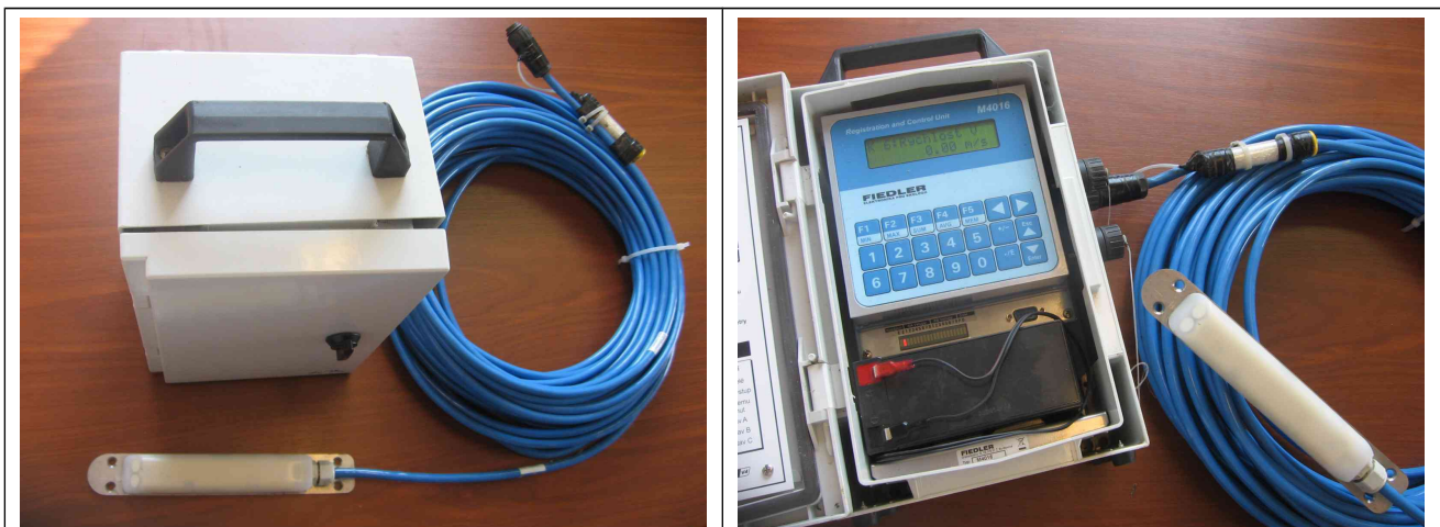
Průtokoměr M4016-KDO: Jednotka M4016-G3 firmy FIEDLER-MÁGR, rychlostní snímač KDO firmy NIVUS GmbH
